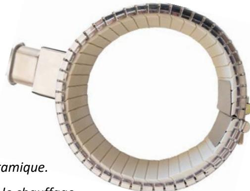
ACGS MESURE réalise des colliers chauffants CERAMIQUE non étanche fabriqués à partir Fil en alliage résistif boudiné dans des modules en céramique.
