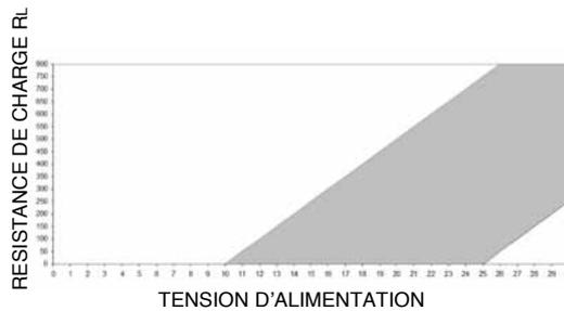
Ce diagramme représente le rapport optimal entre la charge et l'alimentation pour transmetteurs avec sortie 4...20mA.
